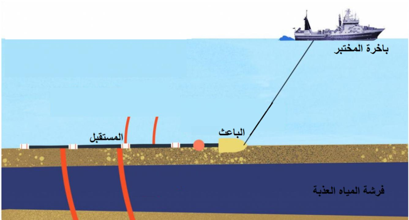
مبدأ التنقيب بواسطة الكهرومغناطيسية ذات المصدر المتحكم (CSEM) وهي طريقة للاستشعار عن بعد تُستخدم بشكل خاص في رسم خرائط قاع البحر. © MARCAN
