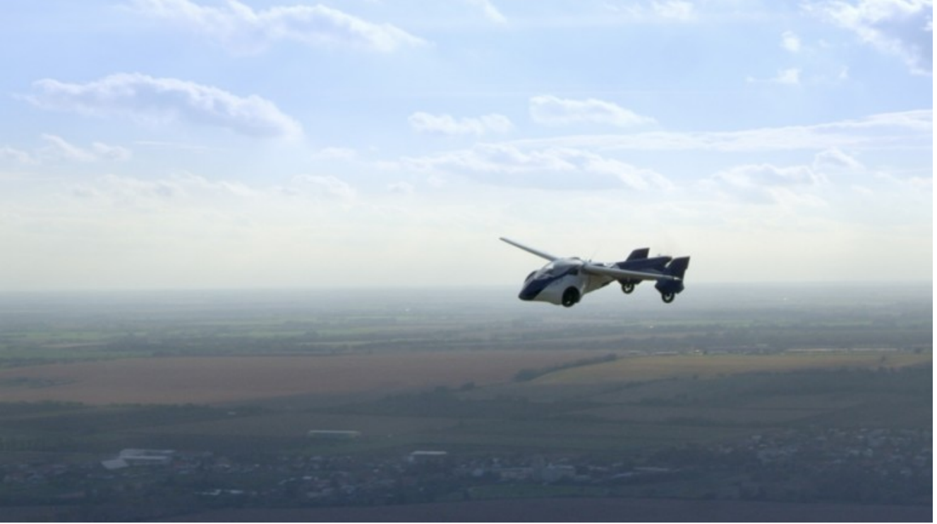
صورة 2. "Aeromobil 3.0" وهي محلقة في الجو في وضعية الطائرة
