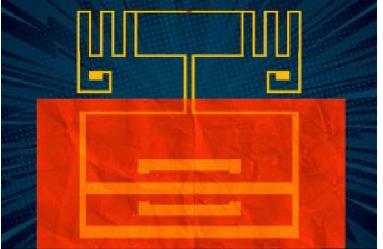
(Rectenna) أو هوائي التصحيح هو الجهاز المستعمل في تحويل الموجات الكهرومغناطيسية إلى طاقة كهربائية. يوصل الهوائي بجهاز مصنوع من أشباه موصلات ثنائية الأبعاد، حيث تمر عبرها الموجات الكهرومغناطيسية وتحوّل إلى تيار كهربائي يُستعمل لتغذية الأجهزة الإلكترونية أو شحن البطاريات.
