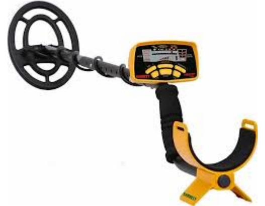
يعمل كاشف المعادن عن طريق استغلال ظاهرة الحث الكهرومغناطيسي (المكتشفة من طرف العالم "ميشال فراادي" سنة 1831)، والتي تتلخص في كون كل جسم موصل للتيار الكهربائي يتعرض لتغير في المجال المغناطيسي (سواء تغير في الشدة أو في الاتجاه)، الشيء الذي يولد تيارات كهربائية محثة داخل الجسم الموصل تسمى تيارات Foucault .
